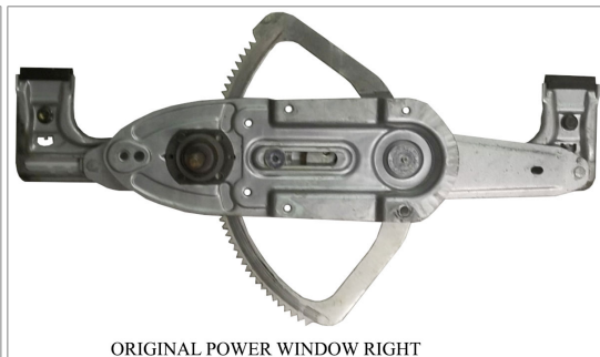
ORIGINAL POWER WINDOW RIGHT ALZACRISTALLI ELETTRICO ORIGINALE DX
